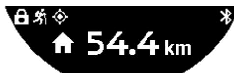
Auf dem Rückweg zum Ausgangspunkt führt die Uhr Sie mit Hilfe des GPS-Signals. Die Daten werden anhand des empfangenen GPS-Signals permanent neu berechnet. Bei entsprechenden Umgebungsbedingungen kann es vorkommen, dass das Signal kurz abbricht. Die Uhr zeigt Ihnen dann mit einem blinkenden Satellitensymbol an, dass der GPS-Empfang nicht ausreicht, um Sie genau zu leiten.
