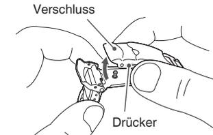
**3 Öffnen Sie die zweiteilige Faltschließe der Tauchbandverlängerung in Pfeilrichtung.**
