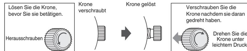
\* Drehen Sie die Krone beim Verschrauben langsam und vorsichtig und achten Sie darauf, dass die Schraube richtig einrastet. Schrauben Sie sie nicht unter Kraftanwendung ein, weil dadurch das Gewinde der Krone beschädigt werden kann.
