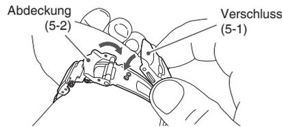
\* Um die Tauchbandverlängerung zusammenzuschieben, führen Sie die obigen Schritte umgekehrt durch. Wenn die zweiteilige Faltschließe der Tauchbandverlängerung vollständig zusammengeschoben ist, klickt sie genauso ein wie beim Öffnen.
