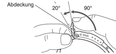
**2** Zum Herausziehen des Schiebers ziehen Sie das Armband auf der 6-Uhr-Seite der Uhr leicht entlang der geschwungenen Linie des Armbandes.
