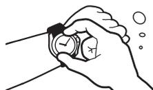
Die Bewegung der drehbaren Lünette kann unter Wasser geringfügig schwergängiger sein. Dies ist keine Störung.
